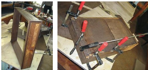
**СПЛАЧИВАНИЕ ДНИЩ ЯЩИКОВ С ВСТАВКОЙ В ЗАЗОРЫ РЕСТАВРАЦИОННОГО МАТЕРИАЛА**
