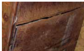
Деформация дна ящика
