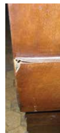
Отслоение шпона на боковой части
