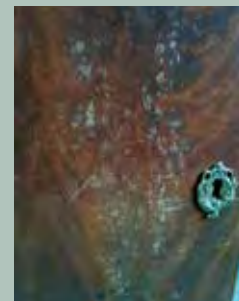
Разрушение полировки, поражение грибком.
