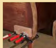
Исправление деформаций задней стенки.
