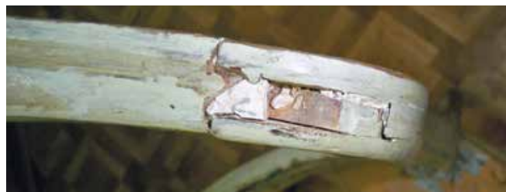
Разрушение креплений деталей спинки.
