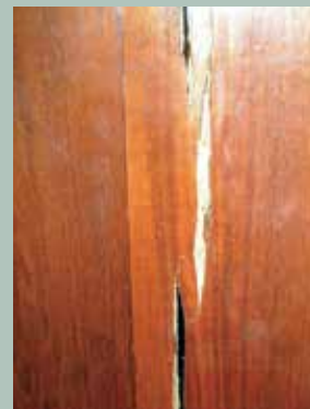
Продольные сквозные трещины на торце
