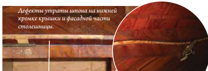
Утрачена кромка темного палисандра на крышке в виде «спинки ослика» – видна основа хвойных пород.
