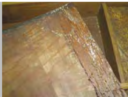
Выходы жука-древоточца с оборотной стороны столешницы. В верхней части – грибковые поражения.
