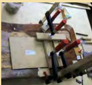
Восстановление шпона на крышке бюро.
