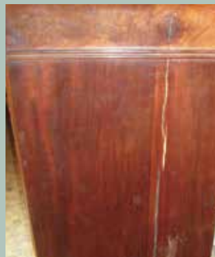
Продольные сквозные трещины на торце
