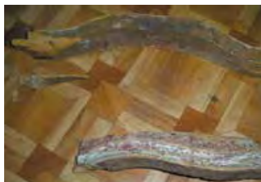
Сколы, трещины, утраты древесины в местах креплений.
