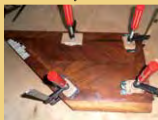
Укрепление набора на правой торцевой части бюро.
