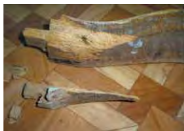
Сколы, трещины, утраты древесины в местах креплений.
