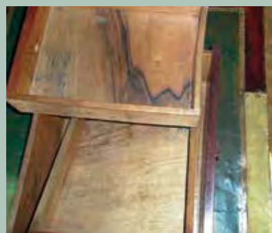
Деформация элементов конструкции ящиков.
