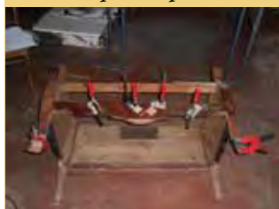
Восстановление набора фасадной части.
