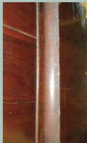
Трещины и дефекты фанеровки.
