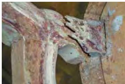
Расщепление древесины в местах крепления спинки к царговому поясу.
