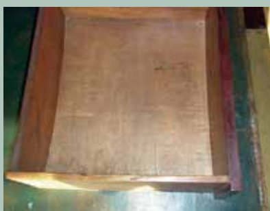
Деформация элементов конструкции ящиков.
