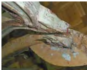
Расщепление древесины в местах крепления спинки к царговому поясу.
