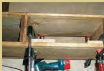
Процесс исправления деформаций конструкции секретера.
