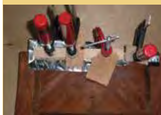
Выпрямление деформации плоскостей ящика
