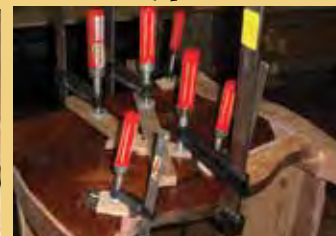
Укрепление набора на правой торцевой части бюро.
